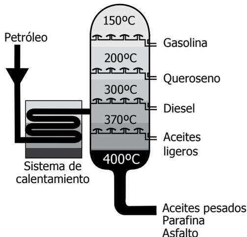
Si en la torre de destilación se daña el sistema de calentamiento, impidiendo llegar a temperaturas superiores a 250°C, se esperaría separar
